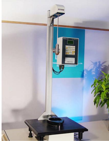
图 1. Labthink BMC-B1 落镖冲击试验仪
